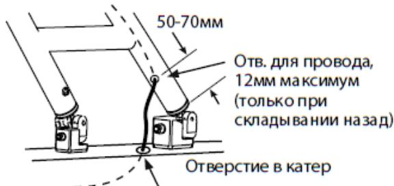
**ВНИМАНИЕ:** Можно протянуть провода к колонкам и другим аксессуарам, добавив отверстия для проводов до 12мм. Избегайте монолитных участков труб, как показано справа.
